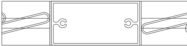
SEZIONE ORIZZONTALE SUL NODO CENTRALE DUE ANTE 132,5
